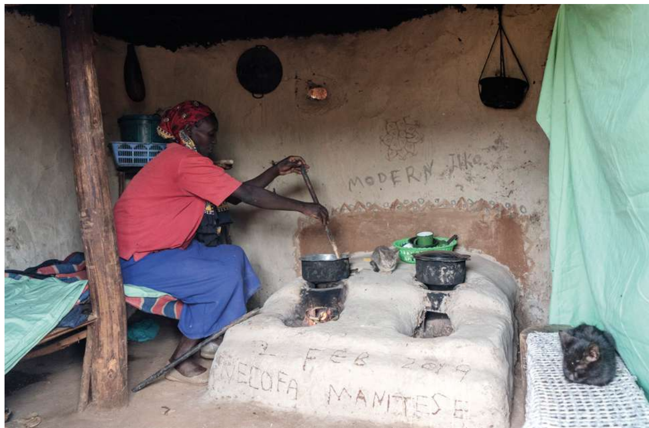
Il forno migliorato è costituito da una struttura in ferro circolare che viene rivestita di argilla, consentendo così di trattenere meglio il calore rispetto ai comuni forni "a tre pietre". © Alessandro Grassani, 2019
